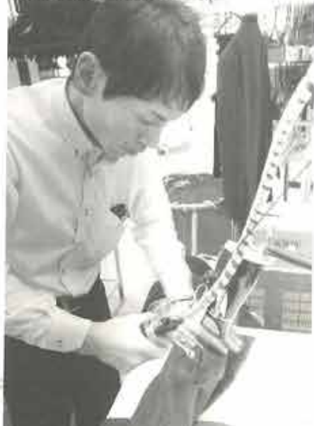
染み、ほつれ、破れなどの箇所が分かっている。工場で、きちんと対応できる。写真に、特殊な機械と洗剤を使って染みを抜いているところだ
